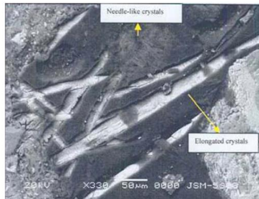
Εικόνα 22. Βελονοειδής μορφής, επιμηκυμένος σχηματισμός κρυστάλλων PENETRON® σε ρωγμές
