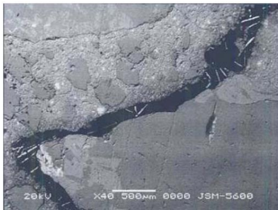
Εικόνα 21. Εικόνα Οπισθοσκεδαζομένων Ηλεκτρονίων (BEI) των κρυστάλλων PENETRON® που σχηματίζονται σε μια ρωγμή 7
